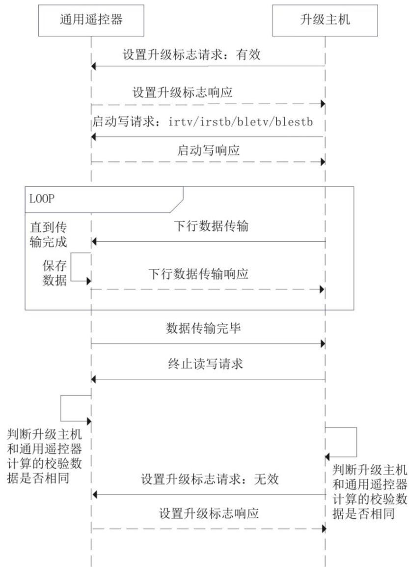
图 E.6 遥控基础信息传输流程
