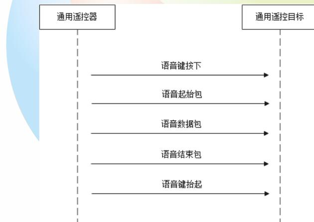
图 D.1 主动触发语音控制流程
