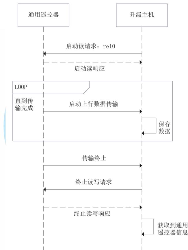
图 E.4 读取三模通用遥控器硬件信息流程
