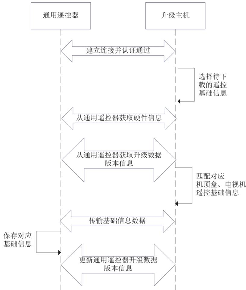
图 E.3 遥控基础信息整体下载流程
