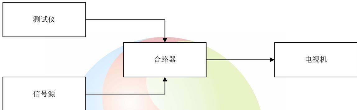
图7 频段内选择性测量框图
