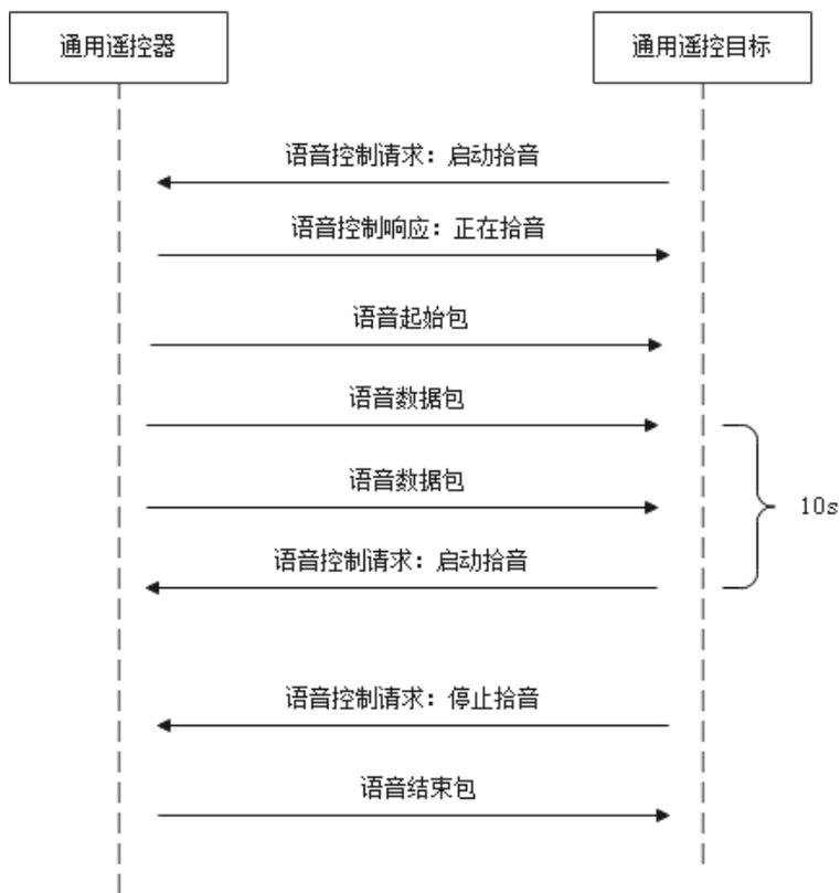
图 D.2 被动触发语音控制流程
